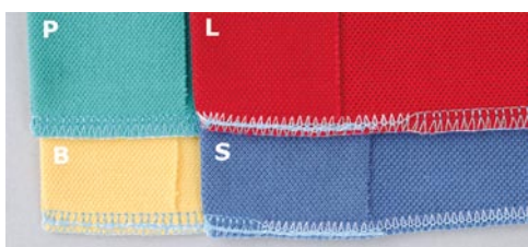
P: Normální šití B: Zatažení řetízku L: Zatažení řetízku s uvolněním na začátku šití S: Speciální zatažení P: General plain seaming B: Back latching L: Back latching with release at the beginning of sewing S: Special back latching
