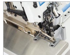
US041: horizontální odstřih řetízku US041: side suction type thread trimmer (horizontal type)
