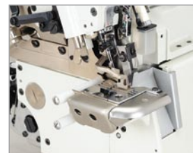
SS038: vertikální odstřih řetízku SS038: Side suction type thread trimmer (vertical type).
